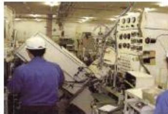
●Cグレードは例えば、想定される地震における挙動により転倒など何らかの被害発生の可能性が高いと判断される設備等。
